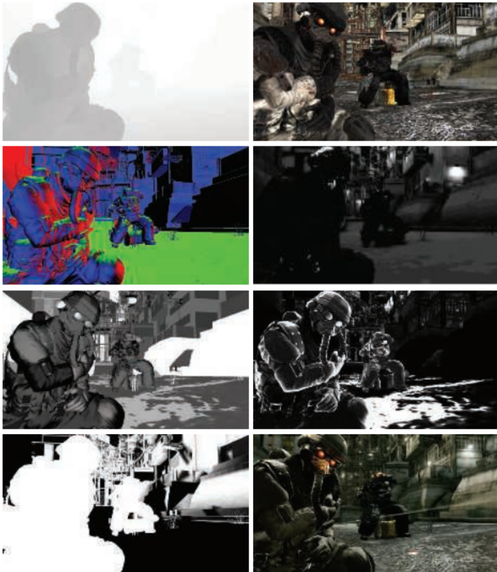
图 20.2：用于延迟着色的 G-buffer，在一些情况下可以将其转换为颜色输出，用于可视化、调试等目的。左边一列从上到下分别是：深度缓冲，法线缓冲，粗糙度缓冲和阳光遮挡（sunlight occlusion）。右边一列从上到下分别是：纹理颜色（又称反照率 albedo 纹理），光照强度，高光强度，和接近最终的图像（没有运动模糊）。[1809]
