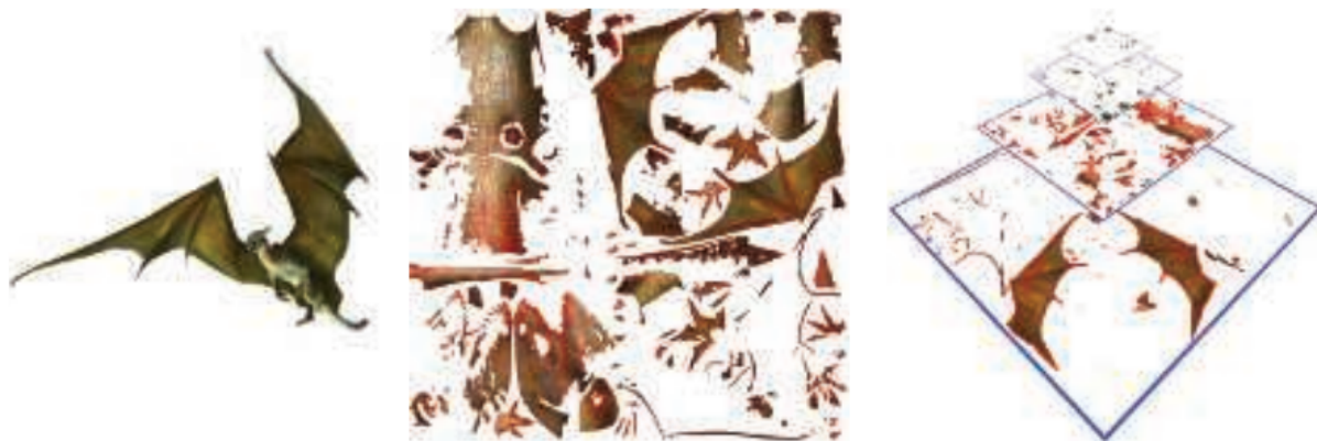
图 20.14：对象空间纹理着色。左边是最终的渲染结果，包括了动态模糊。中间则展示了图表中的可见三角形。在右边，每个三角形会根据其屏幕覆盖率，插入到适当的 mipmap 层级中，以便在最终的基于相机的光栅化 pass 中进行使用。[48]
